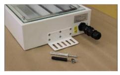
Steckverbindung in Durchgangsverdrahtung. INPUT-Seite für die Stromversorgung und OUTPUT-Seite für den Anschluss an die nächste Leuchte. Der letzte OUTPUT-Stecker an der letzten Leuchte in der Reihe dient als ungenutzter Endanschluss.
