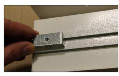
6. Die gebogenen Verriegelungsklammern stützen sich gegen die Rasterrippe. Drücken Sie den Montageadapter vollständig in das Raster
